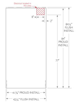
TOP VIEW FIGURE 3 - FLUSH INSTALL
